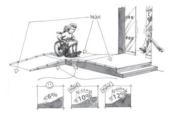
LA PORTE D'ENTRÉE s'ouvre facilement et le passage utile est de 0,77 m minimum.
